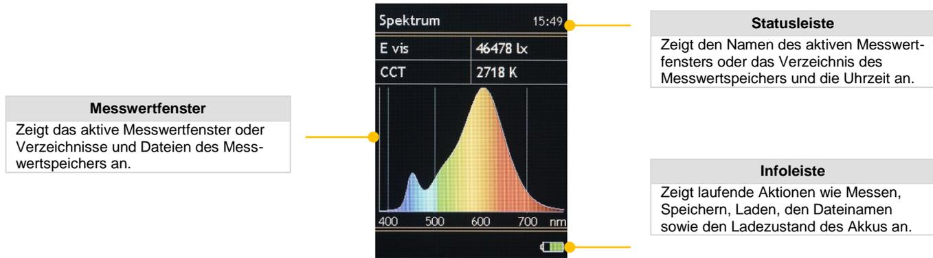
Das Batteriesymbol in der Infoleiste signalisiert den Ladezustand des Akkus oder den Netz- bzw. PC-Betrieb. Die Ladestatus LED signalisiert auch bei ausgeschaltetem Gerät ob der Akku geladen wird oder bereits vollständig geladen ist.
